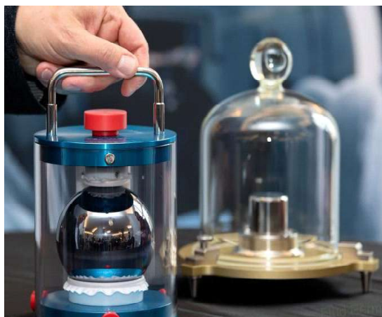
Рис. 8. Преведний платино-иридиевый (справа) и новый эталон килограмма (слева) – кремниевая сфера (фото NIST – National Institute of Standards and Technology )
